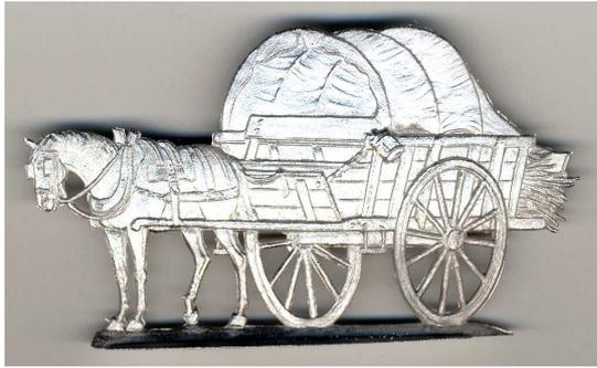
flüssige Zinnlegierung hineingegossen. Die Legierung besteht etwa zur Hälfte aus Zinn und zur anderen Hälfte aus Blei und Antimon. Die genaue Zusammensetzung ist oft das große Geheimnis der Gießer. Die Legierung erkaltet in wenigen Sekunden, obwohl sie ursprünglich ca. 400° heiß war. Man kann dann die blanke Figur mit einer Zange aus der Form lösen und mit kleinen Messern und Feilen den Gussgrat entfernen.
